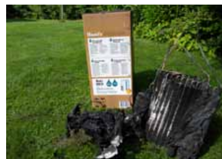
Kondensavfuktare efter brand. Röken från denna relativt lilla brand orsakade skador som krävde över en månads sanering. Tack vare nationella nätverk uppmärksammades att flera av exakt samma typ brunnit. Den aktuella modellen drogs kort efter ”vår” brand bort från marknaden.
